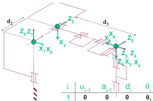
$$\begin{pmatrix} v \\ \omega \end{pmatrix} = J\dot{q} = \begin{bmatrix} J_v \\ J_\omega \end{bmatrix} \dot{q}$$
